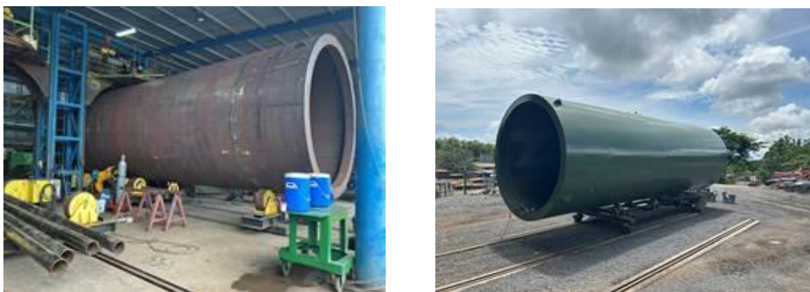
Figura 168. Fabricación de silenciadores de reposición.
