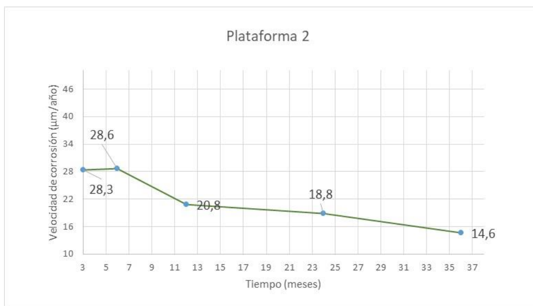
Figura 42. Velocidad de corrosión, determinada por método gravimétrico, para un periodo de exposición de 3, 6, 12 y 24 meses, en el sitio de monitoreo: Plataforma 2.
