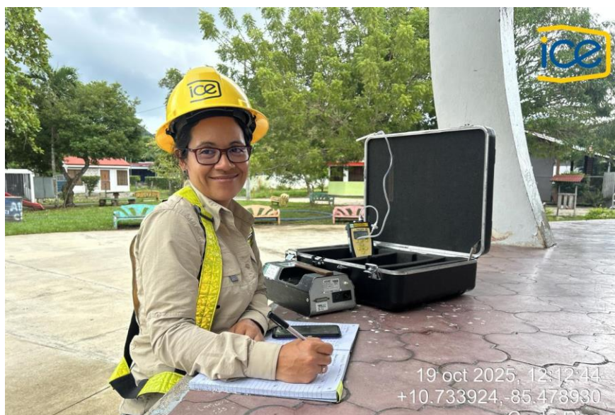
Figura 9. Monitoreos de gases CO 2 y H 2 S.
