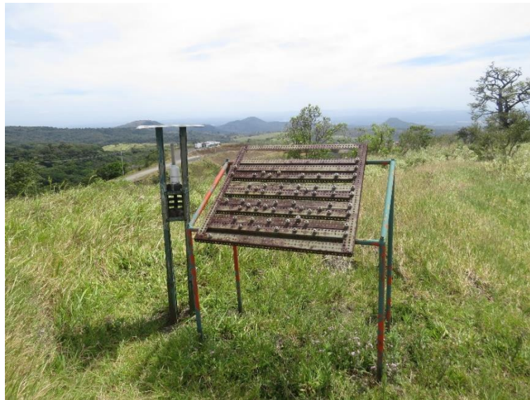
Figura 41. Estación de monitoreo de corrosión en sitio aledaño a la plazoleta PLB-05.
