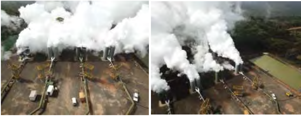
Figura 12. Pruebas de producción de pozos geotérmicos PGP-53 y PGP-83 en PLP-13.
