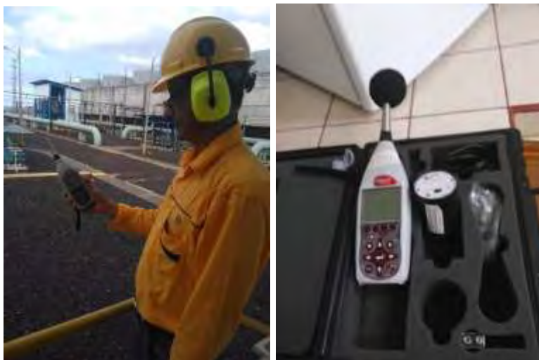
Figura 9. Equipo de medición de ruido y calibrador. Junio 2018.
