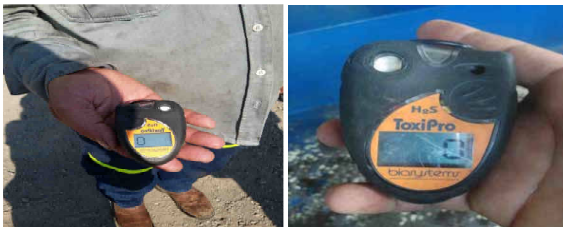
Figura 11. Detectores de gases utilizados en pruebas de producción y labores de perforación de pozos profundos.
