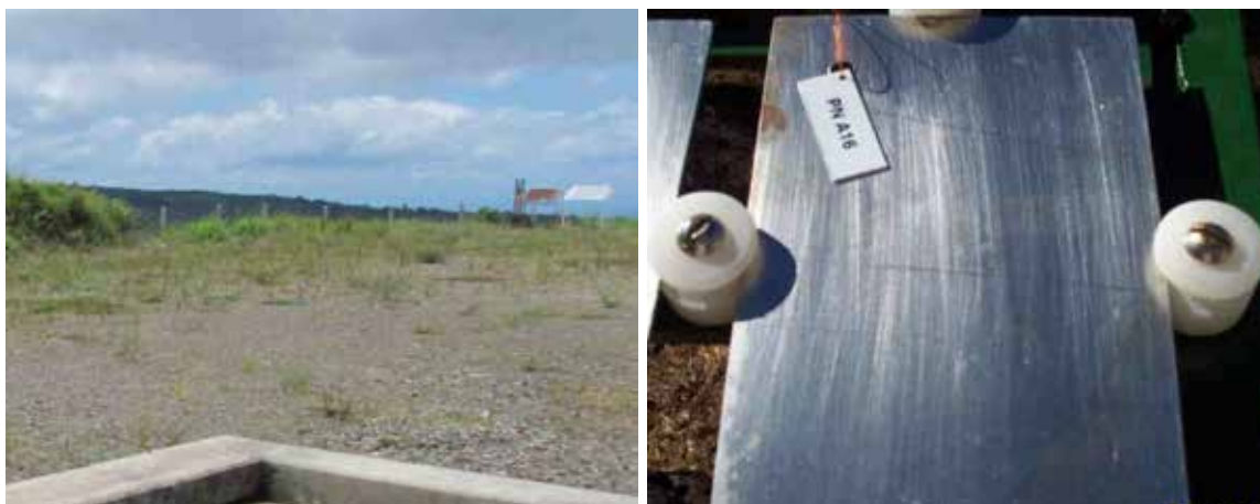
Figura 31. Placas de acero expuestas al ambiente en el AP del PG Borinquen. Estudio de la corrosividad atmosférica.
