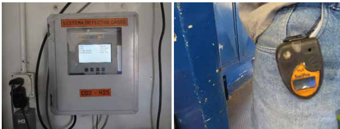
Figura 9. Detectores de gases utilizados en pruebas de producción y labores de perforación de pozos profundos.
