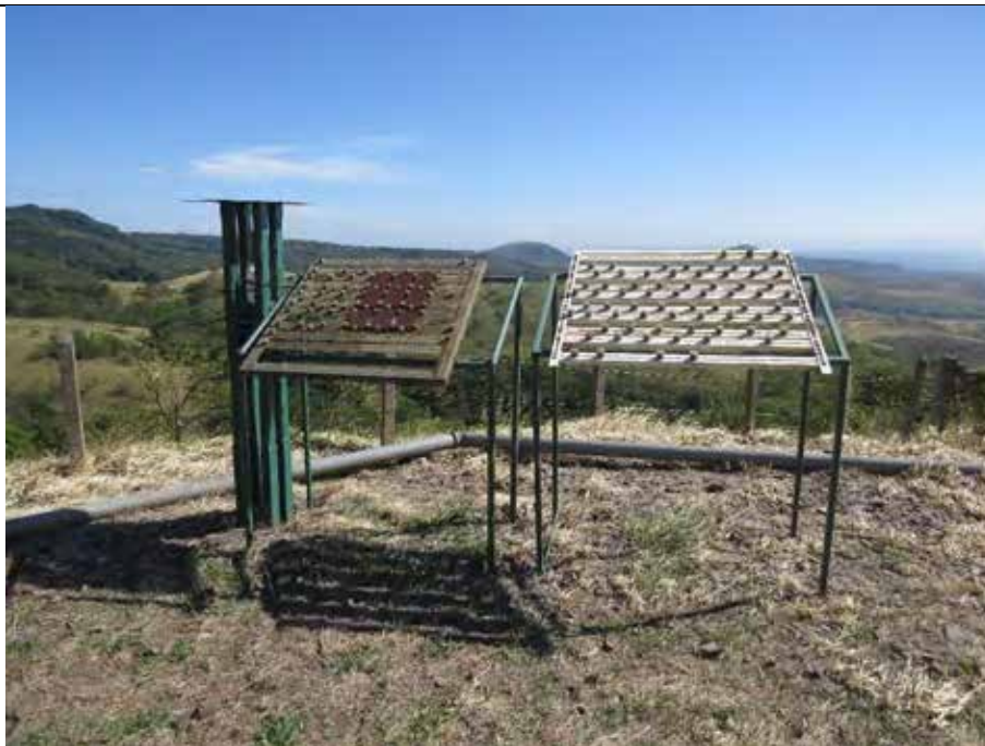
Estructuras metálicas utilizadas en estudio de corrosión ubicadas en la PLB-05 del Proyecto Geotérmico Borinquen. Marzo 2019.
