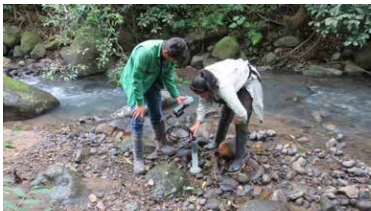
Figura 43. Mediciones directas de parámetros físico químicos para calidad de cuerpos de agua. Proyecto Geotérmico Borinquen, noviembre 2019.
