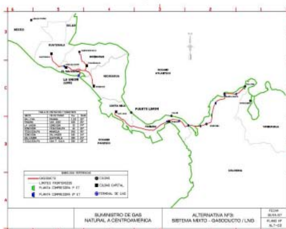
Figura 1II. Alternativa 3 – Sistema Mixto – Gasoducto / GNL
