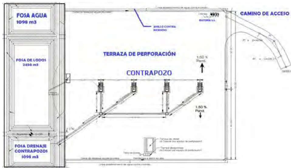
Figura 9 Distribución típica de componentes en una plazoleta de perforación.
