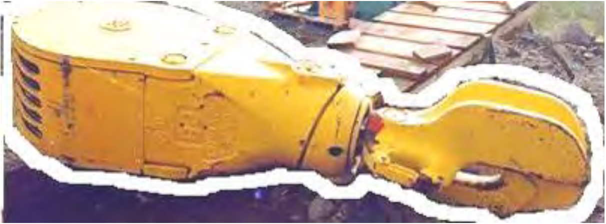
Fotografía 4 Bloque viajero y gancho. A la izquierda se aprecian las poleas, a la derecha el sistema de seguro del gancho. (Imagen JPG).
