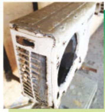
Ilustración 19: Condensador con salitre
