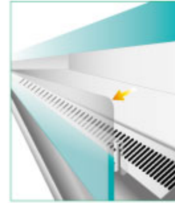
Ilustración 26: Cobertor plástico para reducción de pérdida de aire frío
