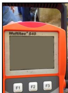
Fotografía. 3 Medidor de concentración de gases.
