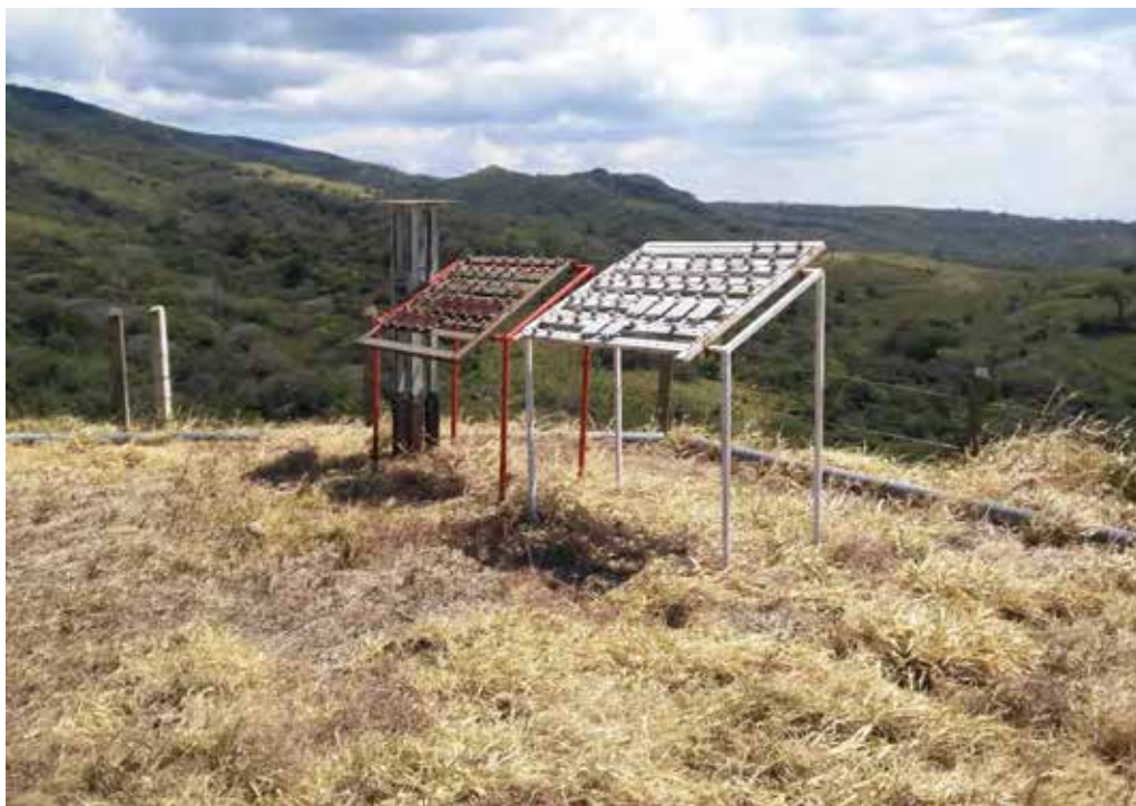
Estructuras metálicas utilizadas en estudio de corrosión ubicadas en la PLB-05 del Proyecto Geotérmico Borinquen. Febrero 2017.
