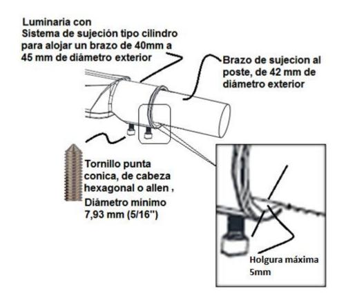
En este caso la holgura o espacio máxima permitida entre el sistema de sujeción tipo cilindro y el brazo de sujeción no debe ser mayor a 5 mm.
