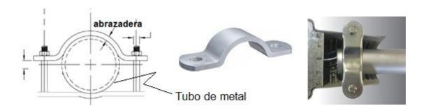
5.2 Este mecanismo o sistema de fijación debe ser adecuado para sujetar con firmeza el cuerpo de la luminaria a un tubo de metal, horizontal, desde 42 mm a 52 mm de diámetro exterior (brazo de suspensión), garantizando un contacto mínimo con el tubo en al menos 20% de su circunferencia.
