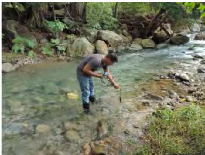
Figura 59. Mediciones directas de parámetros físico químicos para calidad de cuerpos de agua del PG Las Pailas II.
