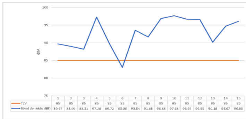
Figura 33. Mediciones de ruido en piso de la perforadora.
