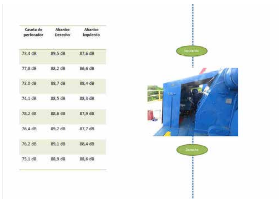
Figura 21: Estudio de ruido realizado a equipos de perforación existentes.
