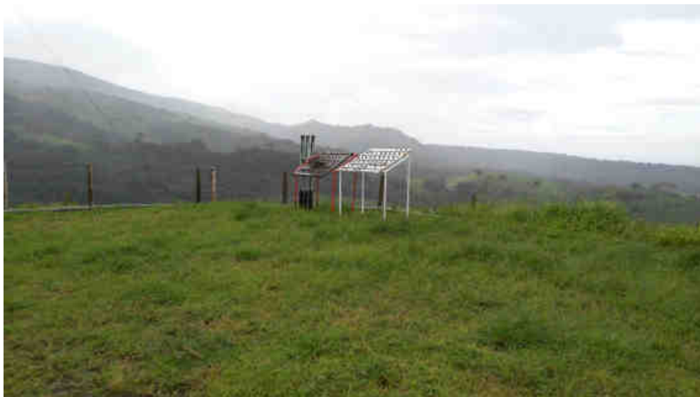
Estructuras metálicas utilizadas en estudio de corrosión ubicadas en la PLB-05 del Proyecto Geotérmico Borinquen. Agosto 2016.
