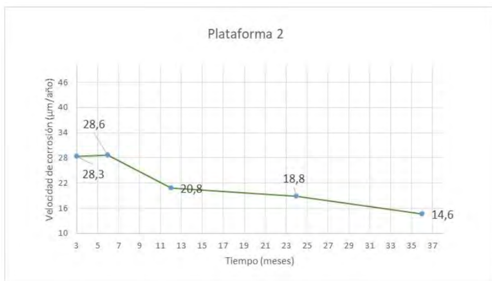
Figura 34. Velocidad de corrosión, determinada por método gravimétrico, para un periodo de exposición de 3, 6, 12 y 24 meses, en el sitio de monitoreo: Plataforma 2.
