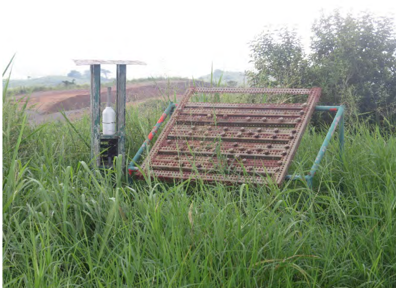
Figura 33. Estación de monitoreo de corrosión en PLB-05.
