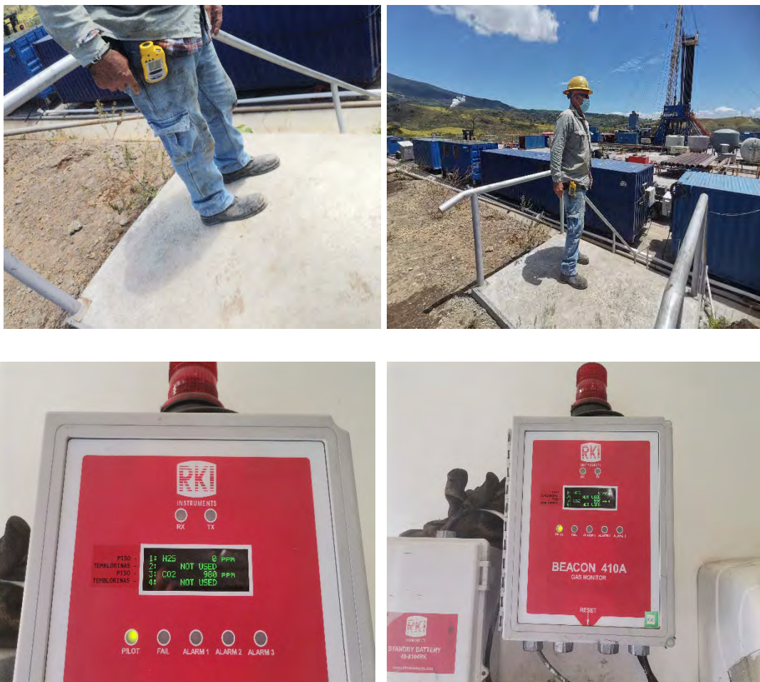
Figura 11. Detectores de gases utilizados en pruebas de producción y labores de perforación de pozos profundos.
