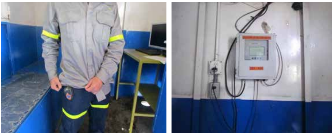
Figura 12. Detectores de gases utilizados en pruebas de producción y labores de perforación de pozos profundos
