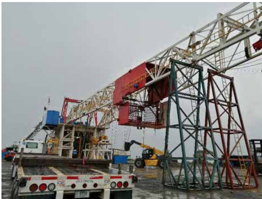
Máquina Perforadora Nacional 110-E en proceso de desarme para traslado del pozo PGB-35 al pozo PGB-05, en la plazoleta PLB-05. Octubre 2019.
