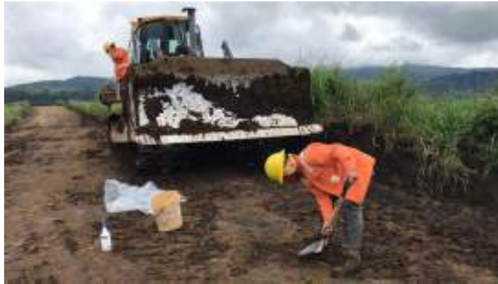
Figura 11. Detención de tractor de orugas con fugas de aceite.
