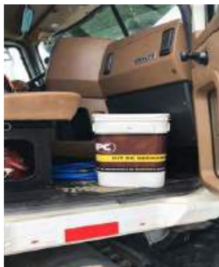
Figura 32. Kit de contención de derrames en la maquinaria.
