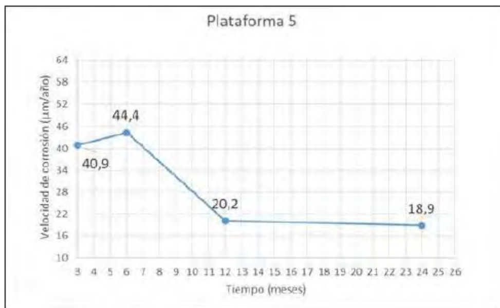
Figura 43. Velocidad de corrosión, determinada por método gravimétrico, para un periodo de exposición de 3, 6, 12 y 24 meses, en el sitio de monitoreo: Plataforma 5.
