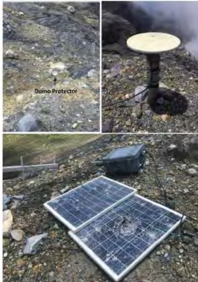
Figura 54. Estado de la antena, el domo, los paneles solares y la caja del equipo GNSS el 3 de setiembre de 2020 en el borde del cráter del volcán Rincón de la Vieja.
