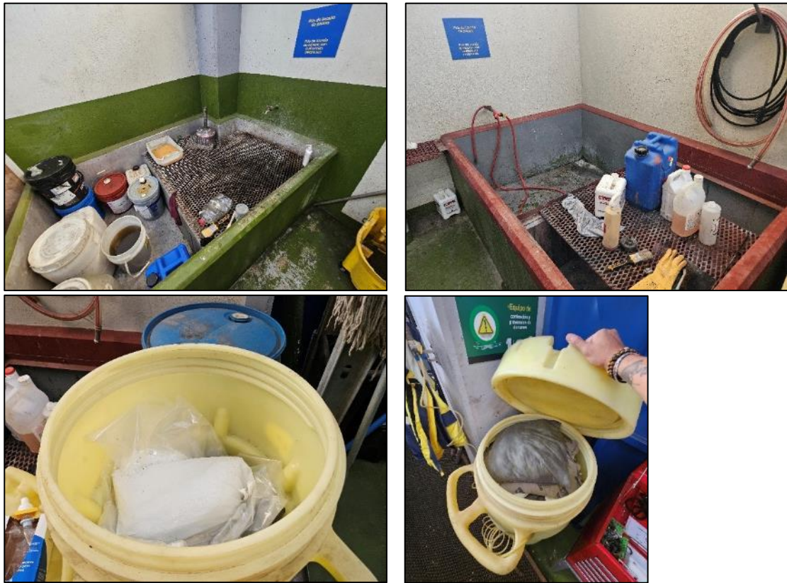
Figura 15 Pilas de lavado de equipos y herramientas, y disponibilidad de kits para el control de derrames en talleres.
