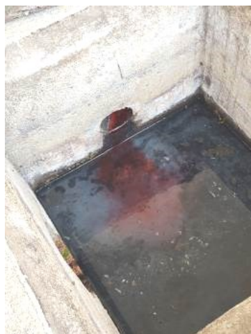
Aplicación de tinte rojo en pila de taller Pailas I Verificación de tinte en caja de registro
