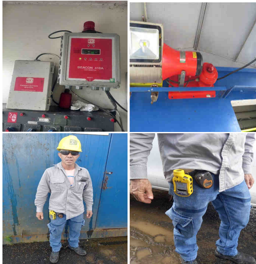
Figura 15. Detectores de gases utilizados en pruebas de producción y labores de perforación de pozos profundos.
