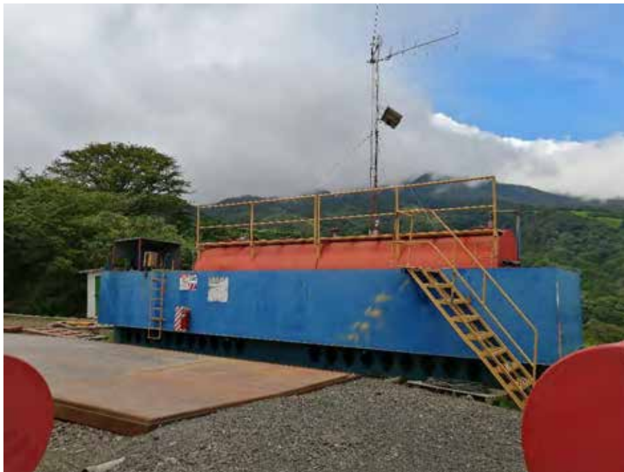
Sistema de almacenamiento de diésel en la máquina perforadora National 110-E, plazoleta PLB-05. Junio 2019.
