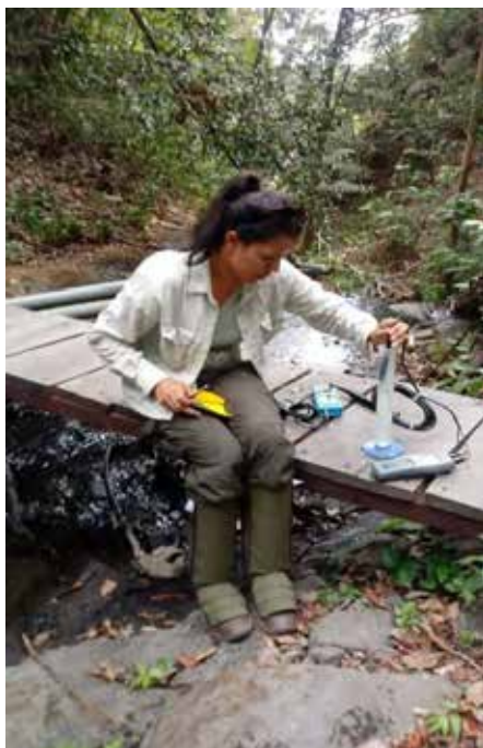
Figura 45. Mediciones directas de parámetros físico químicos para calidad de cuerpos de agua. Proyecto Geotérmico Borinquen, mayo 2019.
