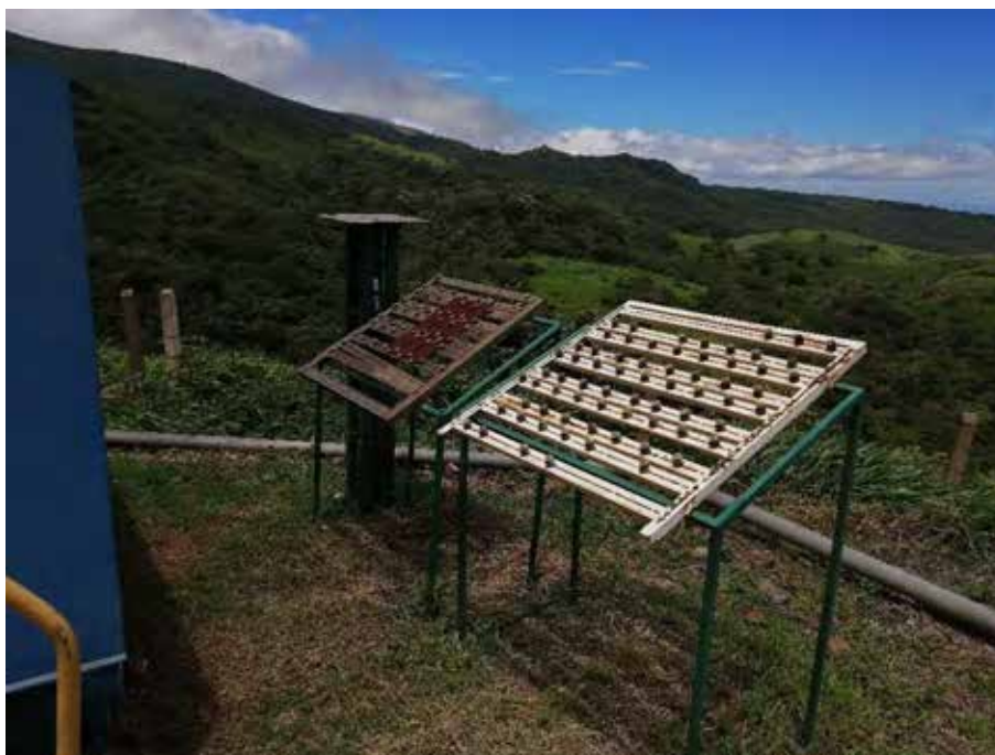
Estructuras metálicas utilizadas en estudio de corrosión ubicadas en la PLB-05 del Proyecto Geotérmico Borinquen. Junio 2019.
