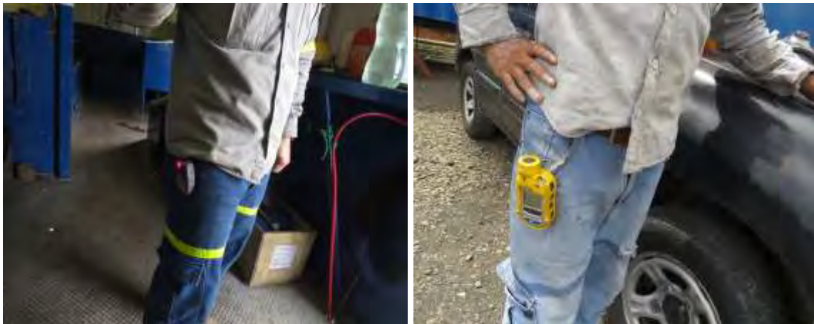
Figura 18. Detectores de gases portátiles en equipos de perforación Cardwell y Kpem.
