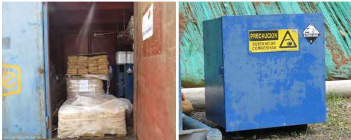
Figura 65. Áreas para almacenamiento de sustancias peligrosas en perforadoras
