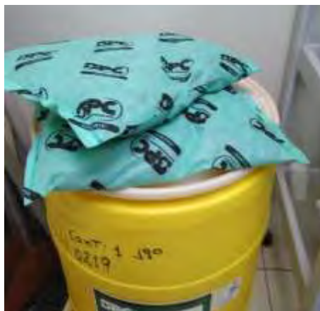
Figura 164. Kit de control de derrames del área química y msds.
