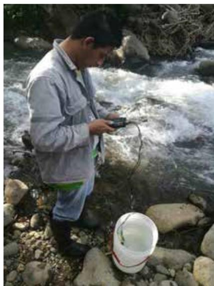
**Figura 63.** Mediciones directas de parámetros físico químicos para calidad de cuerpos de agua. Proyecto Geotérmico Borinquen, febrero 2018.
