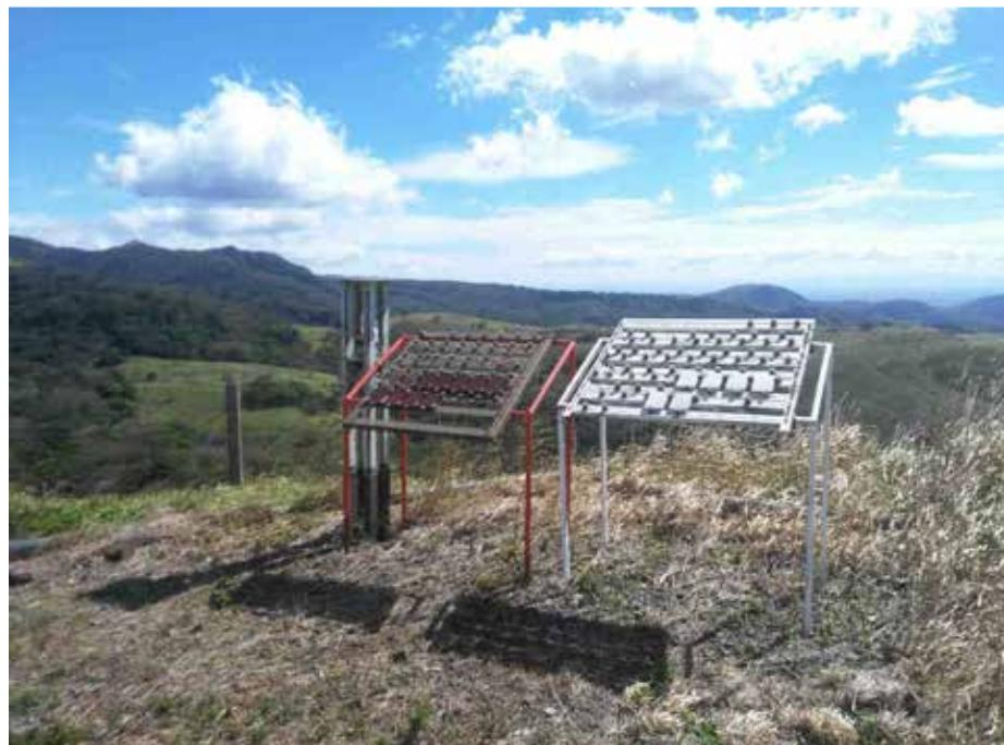
Estructuras metálicas utilizadas en estudio de corrosión ubicadas en la PLB-05 del
