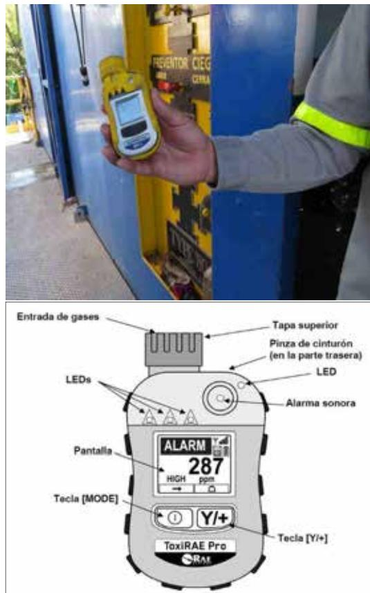
**Figura 13.** Detectores de gases utilizados en pruebas de producción y labores de perforación de pozos profundos
