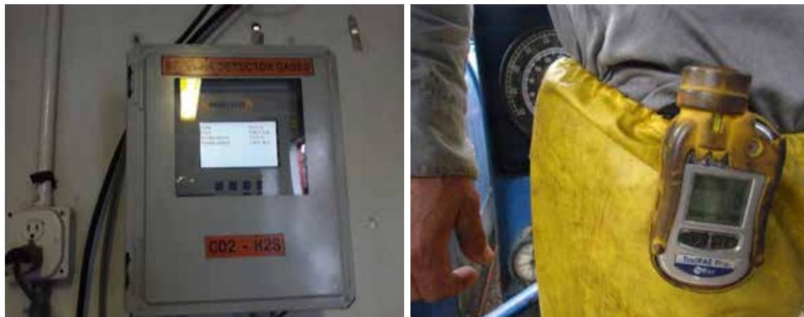
**Figura 10.** Detectores de gases utilizados en pruebas de producción y labores de perforación de pozos profundos
