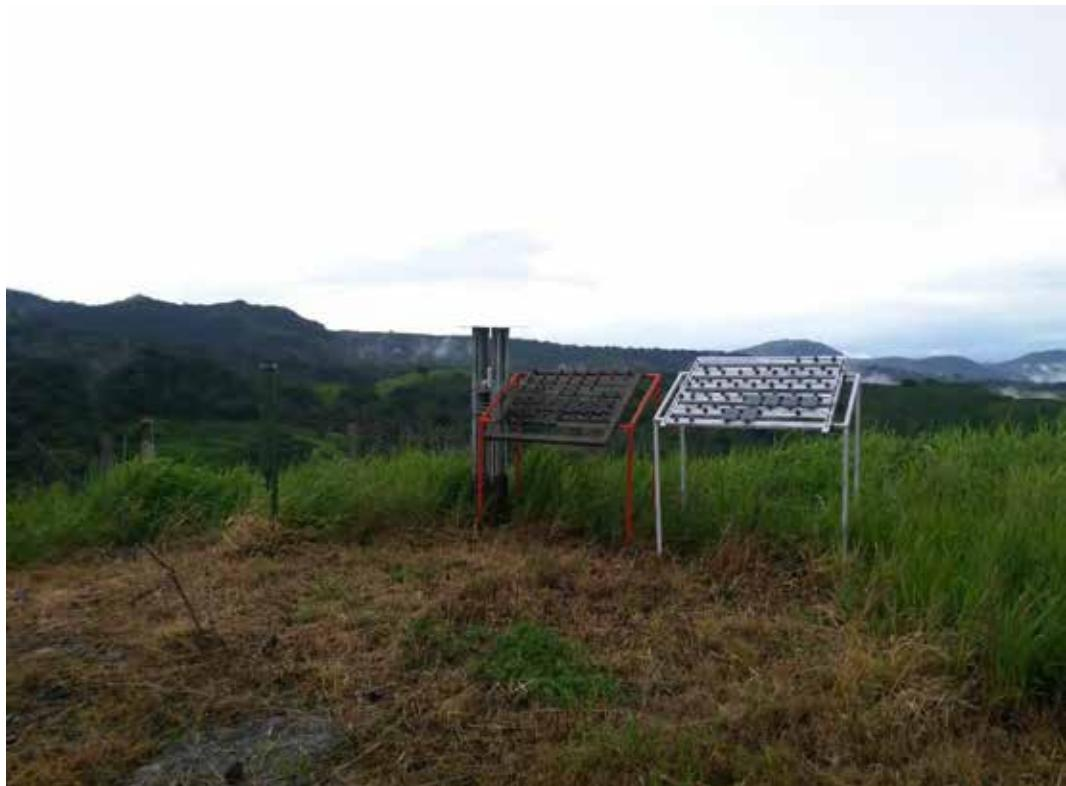
Estructuras metálicas utilizadas en estudio de corrosión ubicadas en la PLB-05 del Proyecto Geotérmico Borinqueñ. Julio 2017.
