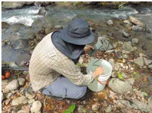
**Figura 50.** Mediciones directas de parámetros físico químicos para calidad de cuerpos de agua. Proyecto Geotérmico Borinquen, mayo 2017.
