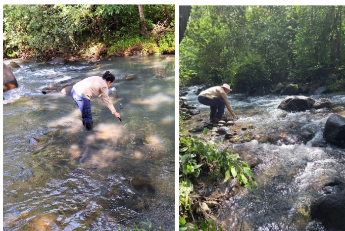
Figura 32 Medición de variables fisicoquímicas y toma de muestra para análisis de calidad de agua
