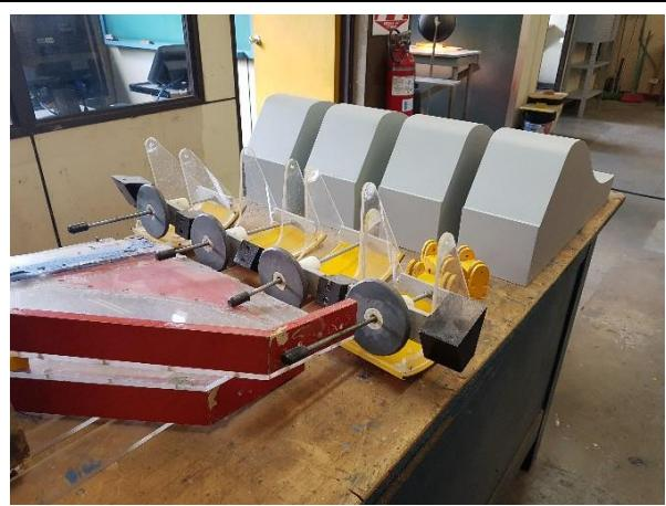
Foto 49: I-5 Partes desmanteladas de un modelo de la compuerta de alivio en las oficinas del ICE en San Jose.
