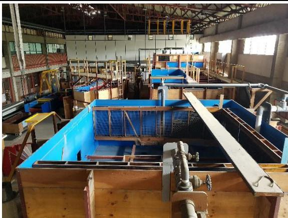
Foto 50: I-5 Taller del modelo físico del ICE, con piezas desmontadas del modelo usado para el proyecto Reventazón.
