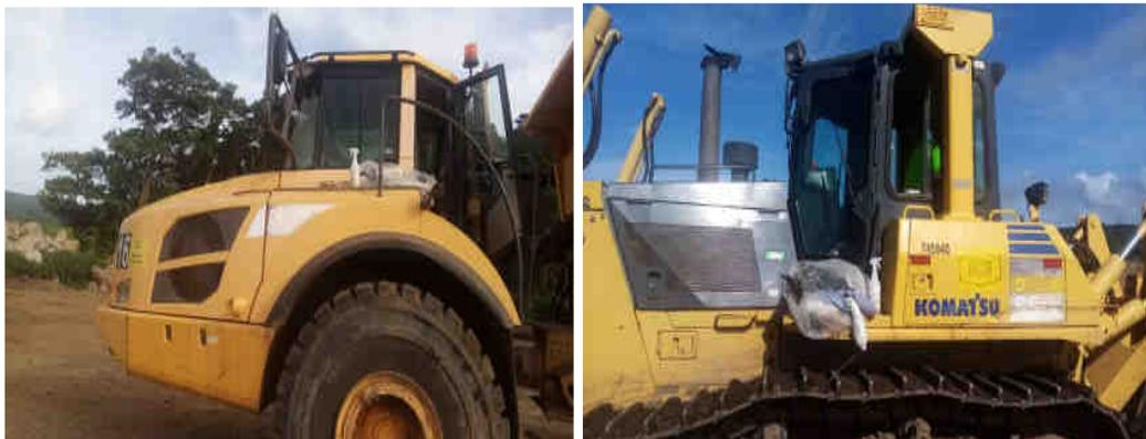
**Figura 39.** Asignación de material de contención de derrames a la maquinaria.
