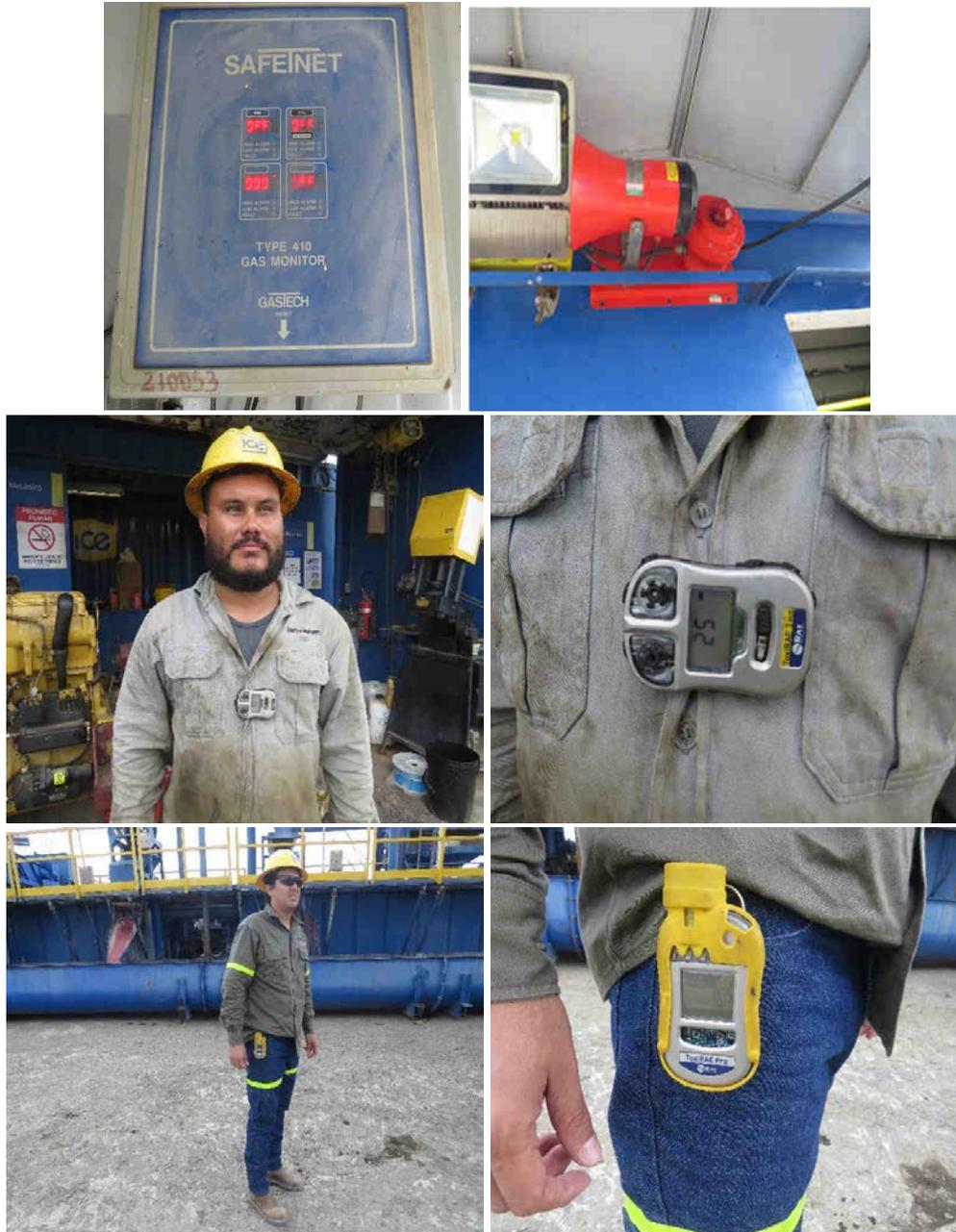
**Figura 15.** Detectores de gases utilizados en pruebas de producción y labores de perforación de pozos profundos.
