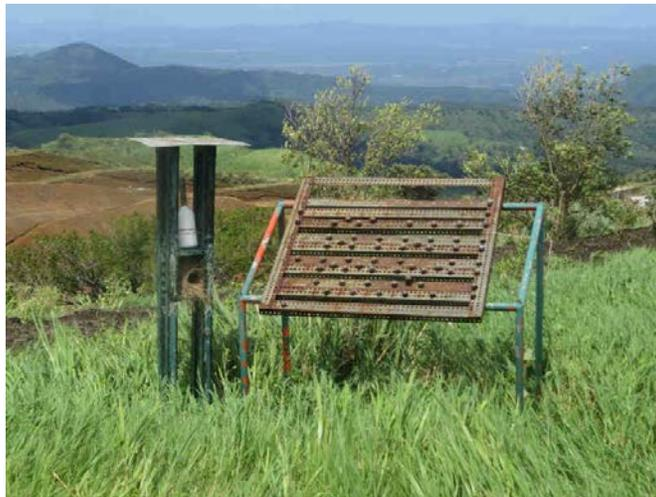
**Figura 49.** Estación de monitoreo de corrosión en PLB-05.
