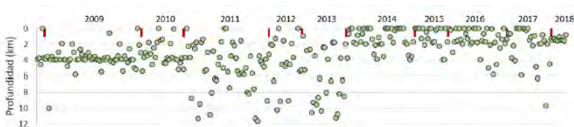
Figura 45. Rangos de profundidad de la sismicidad de la base de datos del catálogo del OSIVAM (Observatorio Sismológico y Vulcanológico de Arenal y Miravalles) para el periodo 2008 al 15 de julio del 2018.
