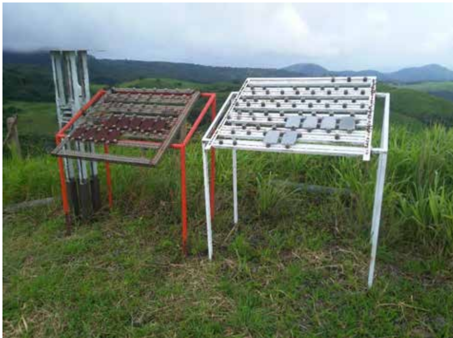
Estructuras metálicas utilizadas en estudio de corrosión ubicadas en la PLB-05 del Proyecto Geotérmico Borinquen. Julio 2018.
