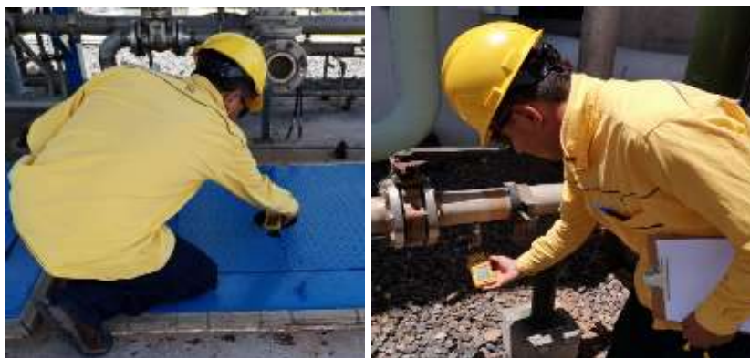
Figura 121. Monitoreo de H 2 S en sistemas de neutralización y drenajes OEC #1, realizado el 30/04/19
