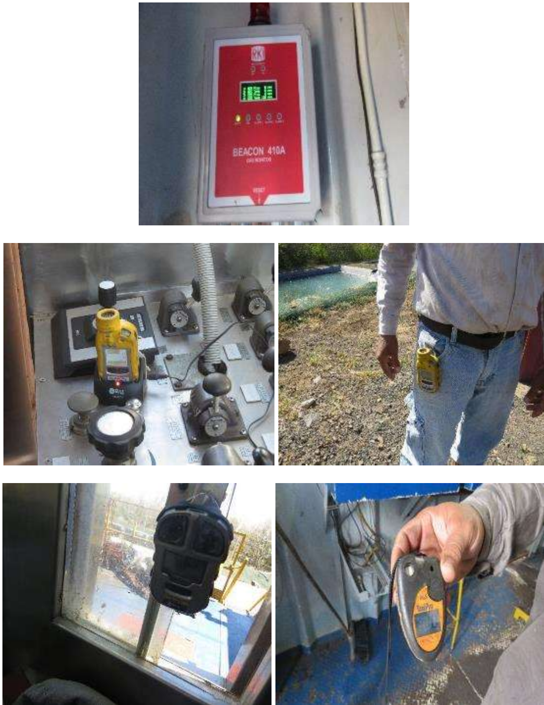
Figura 15: Detectores de gas utilizados en la perforadora Kpem.
