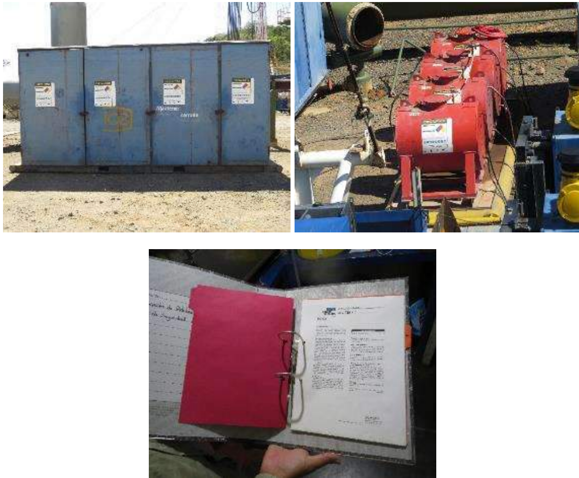
Figura 55. Áreas para almacenamiento de sustancias peligrosas en perforadoras.
