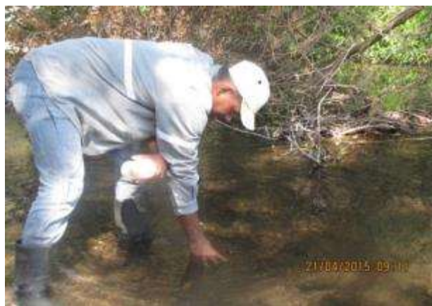
Figura 51. Toma de muestras para análisis de DBO y Nitrógeno amoniacal en abril 2015.
