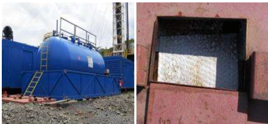
Figura 5. Uso de toallas absorbentes en trampas para aguas oleaginosas.
