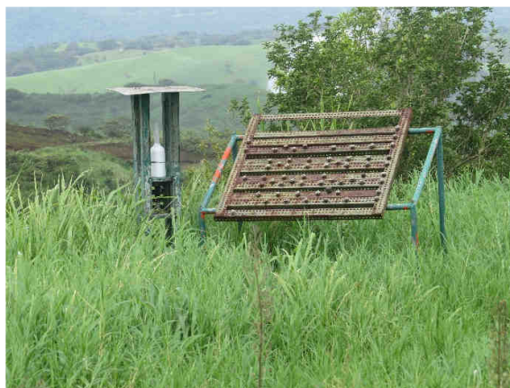
Figura 49. Estación de monitoreo de corrosión en PLB-05.
