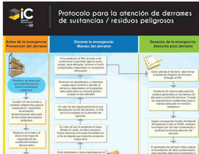
**Figura 72.** Extracto del protocolo de atención de derrames de sustancias peligrosas de IC.
