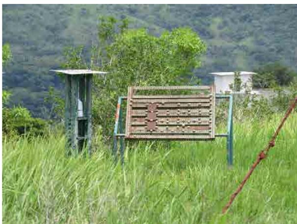
**Figura 38.** Estación de monitoreo de corrosión en PLB-05.
