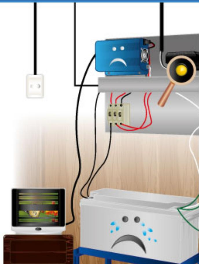
o bornes de la batería, esto puede ocasionar un corto circuito en el sistema, poniendo al usuario en peligro de una descarga eléctrica y un daño irreparable al equipo. **El realizar esta acción es un incumplimiento del contrato y causal del retiro de sistema fotovoltaico.**
