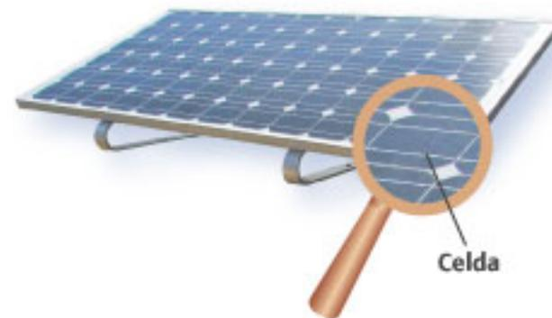
El módulo fotovoltaico recibe la radiación solar en menor cantidad cuando el día está nublado. El módulo produce electricidad mediante la transformación de dicha radiación solar, en corriente eléctrica, a través de un proceso físico-químico. Para que el módulo pueda producir electricidad se debe evitar que el módulo tenga sombras o suciedad que no permitan que la radiación impacte en el módulo fotovoltaico. **En este caso el módulo se comporta como si fuera de noche.**
