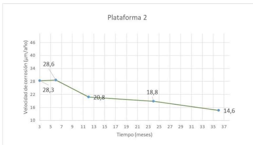
Figura 35. Velocidad de corrosión, determinada por método gravimétrico, para un periodo de exposición de 3, 6, 12 y 24 meses, en el sitio de monitoreo: Plataforma 2.
