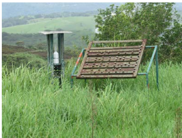
Figura 34. Estación de monitoreo de corrosión en PLB-05.
