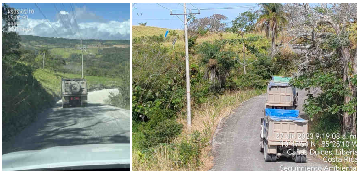
Figura 125. Uso de lona para cubrir material de acarreo en vagonetas.
