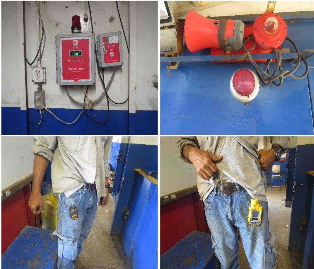
Figura 14. Detectores de gases utilizados en pruebas de producción y labores de perforación de pozos profundos.
