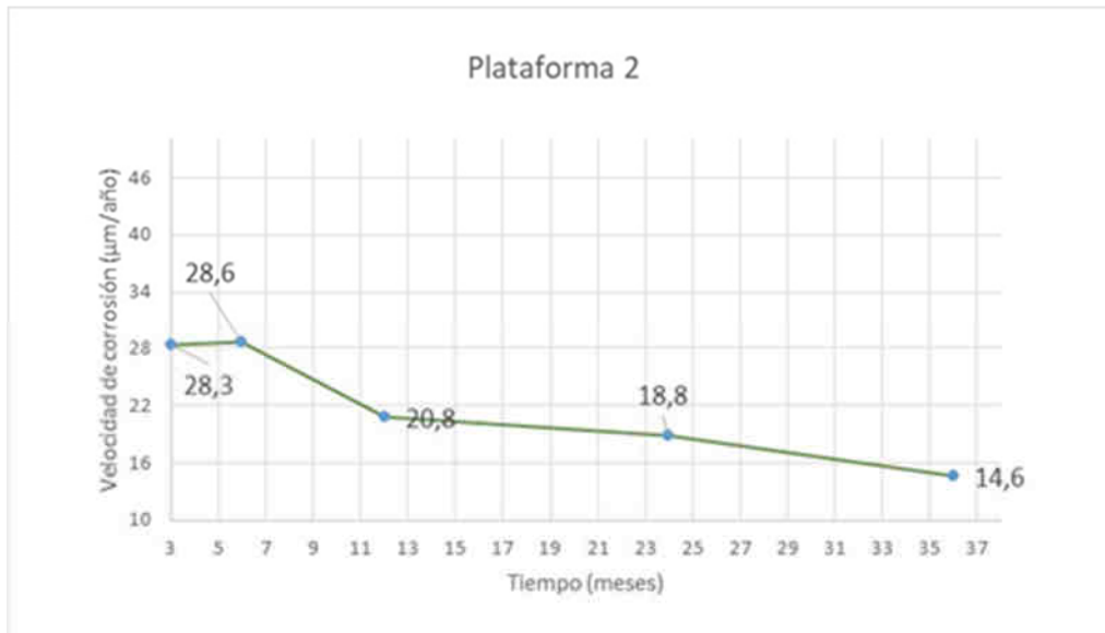
Figura 54. Velocidad de corrosión, determinada por método gravimétrico, para un periodo de exposición de 3, 6, 12 y 24 meses, en el sitio de monitoreo: Plataforma 2.
