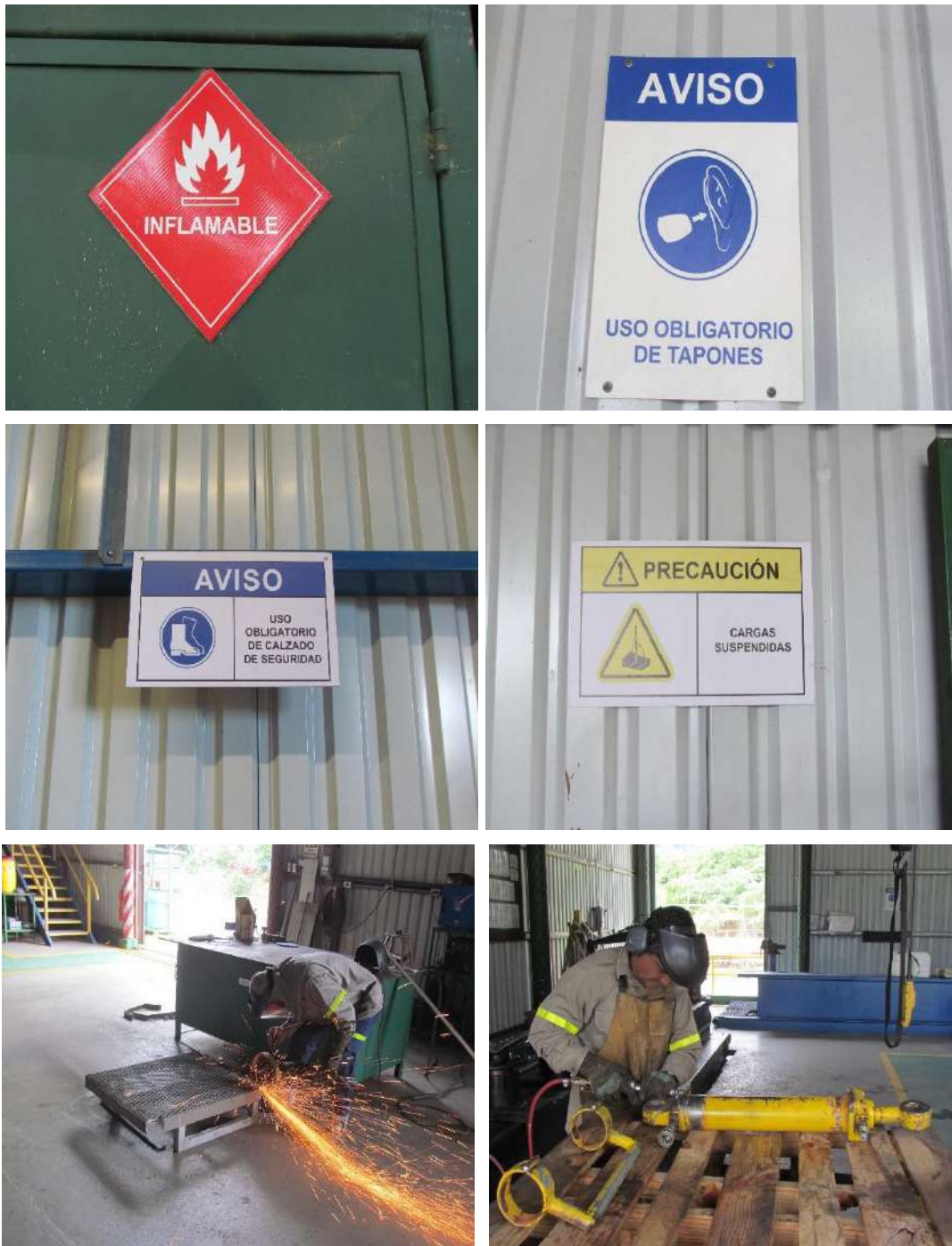
Figura 25. Rotulación preventiva y uso de EPP por parte del personal.
